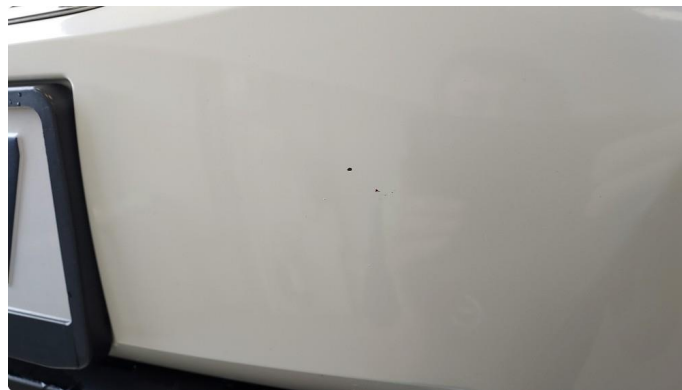
1.4 Noen steinsprut i fanger foran
