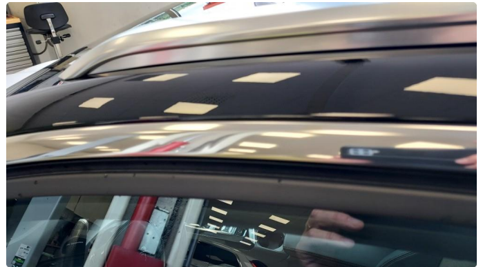
1.1 2 små bulker i chromlist på venstre framdør over vindu.
