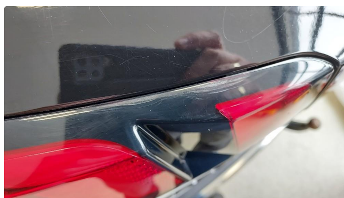
2.1 Litt krakelering på plast i lys bak
