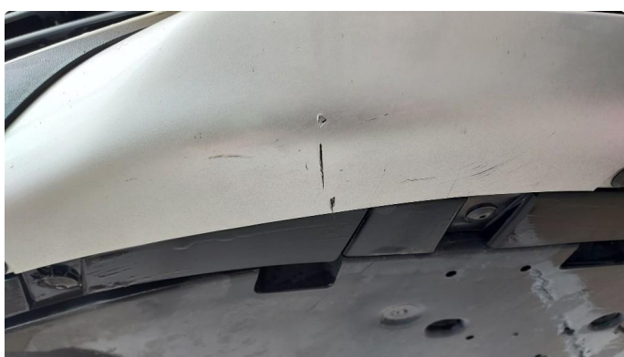
1.5 Ubetydelig oppripet på underside av fanger foran
