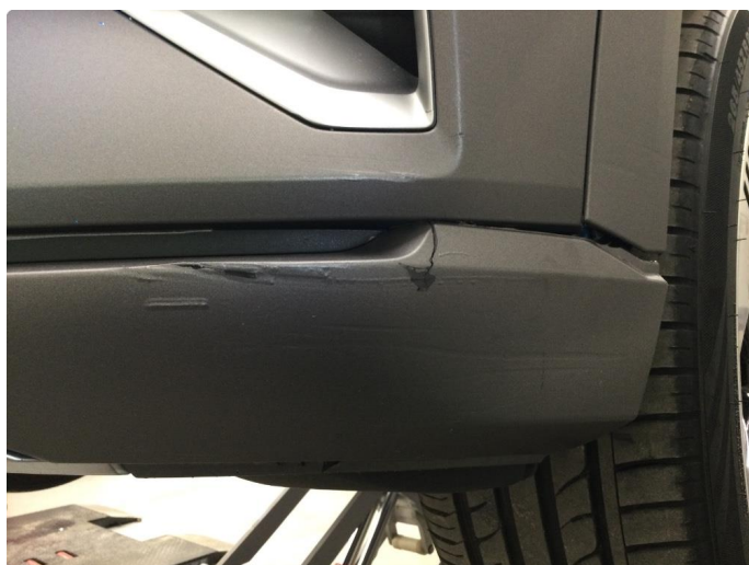
1.5 Sprekk i plastikk
