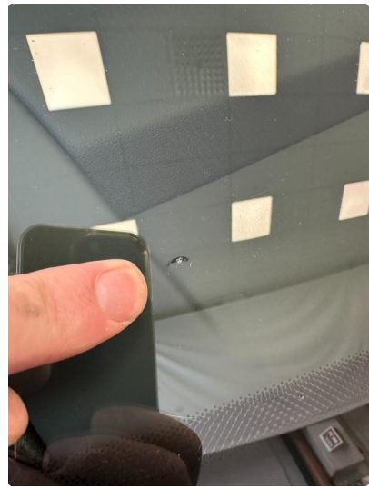
1.4 Steinsprut utenfor synsfelt
