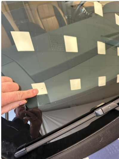
1.4 Steinsprut utenfor synsfelt
