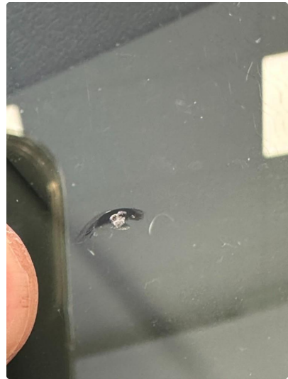
1.4 Steinsprut utenfor synsfelt
