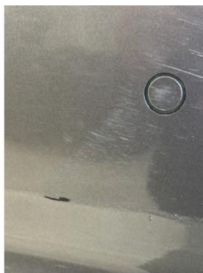
1.1 Noen små hakk/riper i fanger bak
