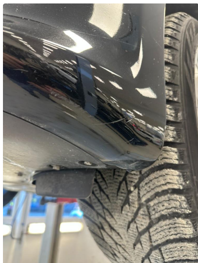
1.2 Noe oppripet på underside av fanger foran
