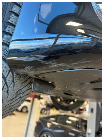
1.2 Noe oppripet på underside av fanger foran
