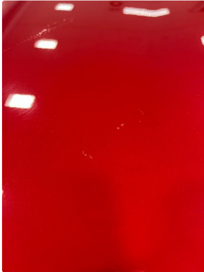
1.1 Noe steinsprut i panser
