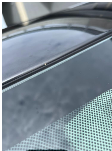
1.8 Korrodert steinsprang framkant tak.
