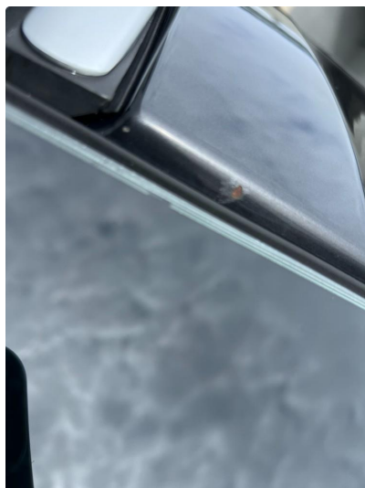
1.8 Korrodert steinsprang framkant tak.
