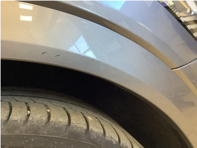
1.1 Liten lakkskade som er flekket på skjermutbygger høyre foran
