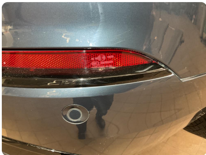
1.1 Generelt mye riper Noe riper runt om på bil trenger lakkrens
