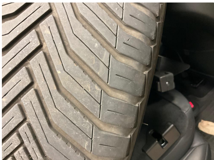
1.2 Skjev slitasje på sommerdekk
