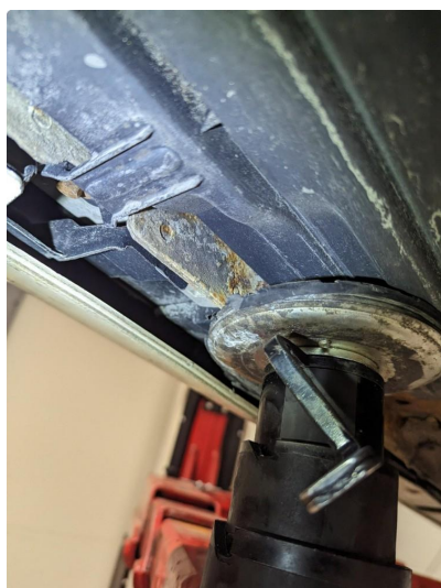
1.2 Noe korrosjon/rust. Normalt iht alder/kilometerstand.
