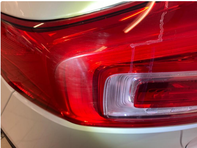
2.1 Defekt / sprukket glass
