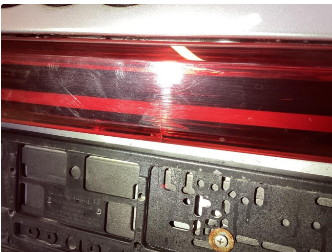
2.1 Defekt / sprukket glass
