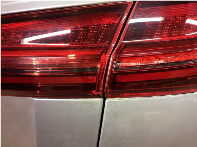
2.1 Defekt / sprukket glass
