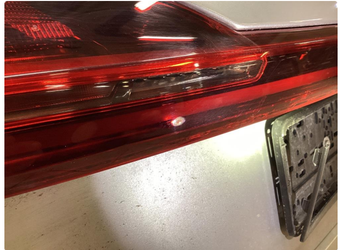
2.1 Defekt / sprukket glass
