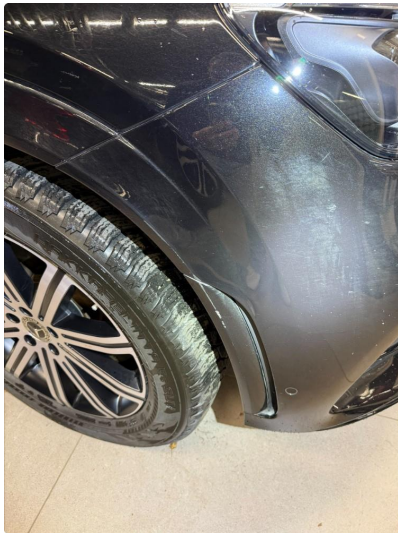
1.2 Ripe(r) ned til grunning
