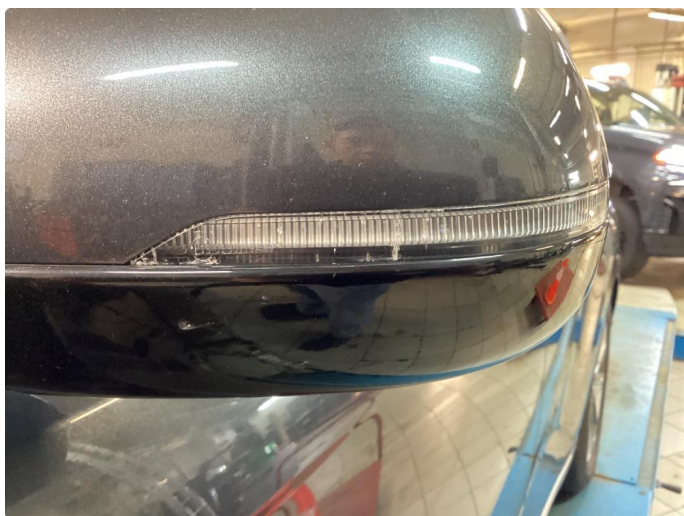
2.1 Krakelering blinklys i speil høyre side foran og venstre side foran
