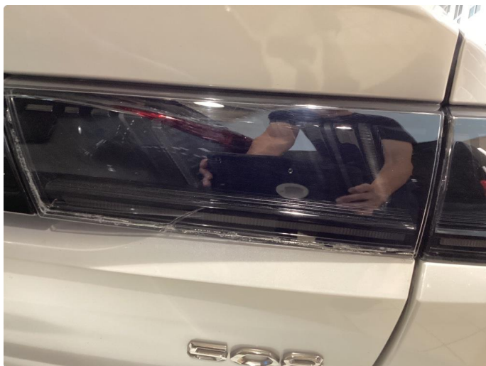
2.1 Krakkelering på lamper, begge bak indre
