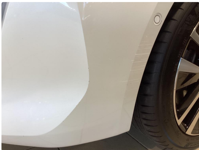
1.6 Riper/steinsprut på støtfanger foran
