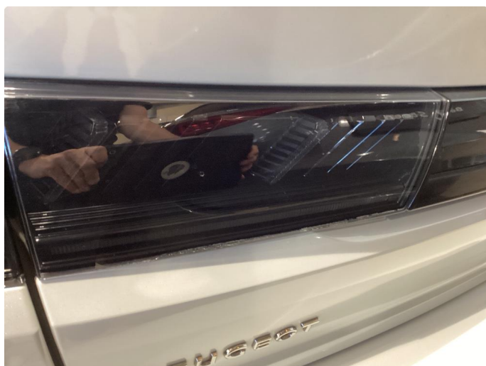
2.1 Krakkelering på lamper, begge bak indre
