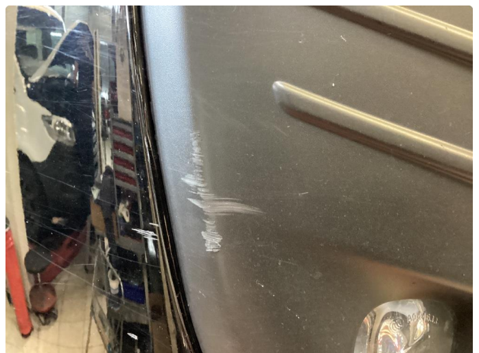
1.3 Ripe(r) ned til grunning
