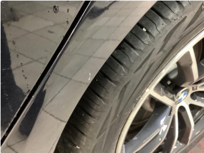
1.1 Ripe(r) ned til grunning
