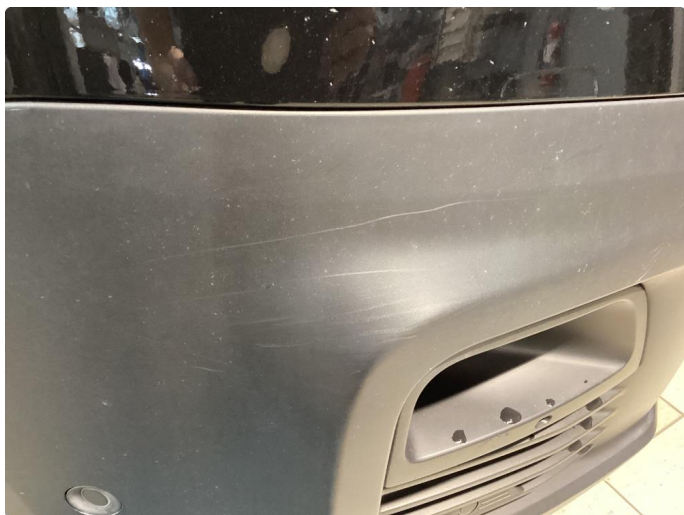
1.8 Riper og steinsprut på støtfanger foran
