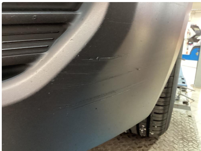
1.8 Riper og steinsprut på støtfanger foran
