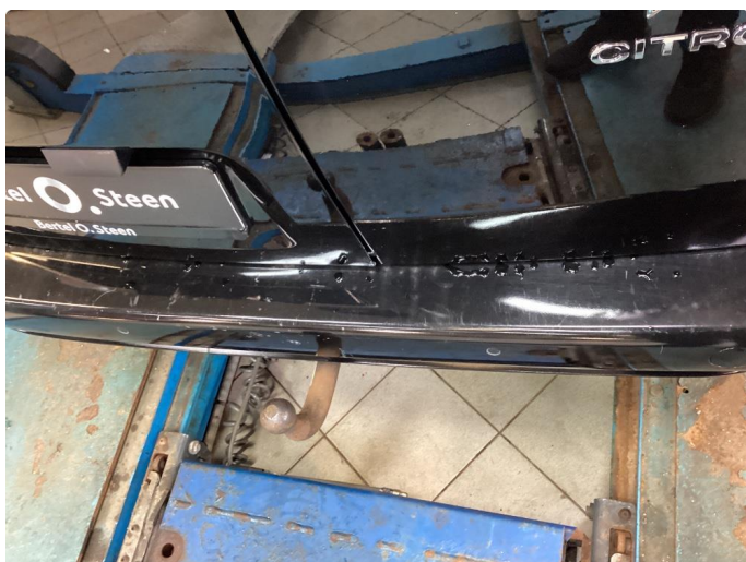
1.7 Riper på støtfanger bak
