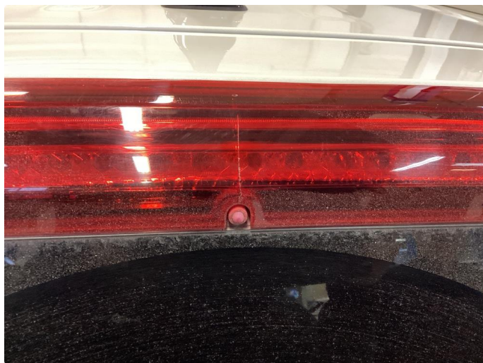
2.1 Defekt / sprukket glass
