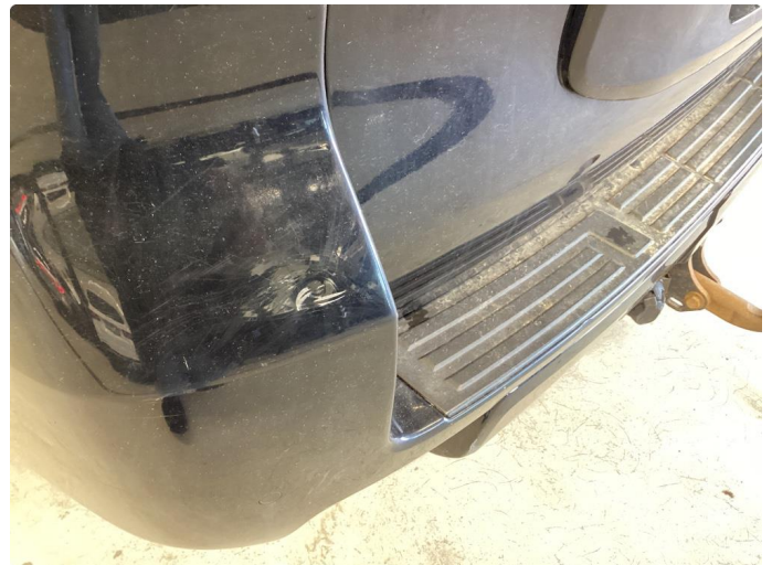
1.3 Ripe(r) ned til grunning
