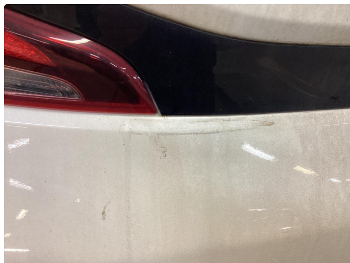
1.1 Påbegynt rust dannelse
