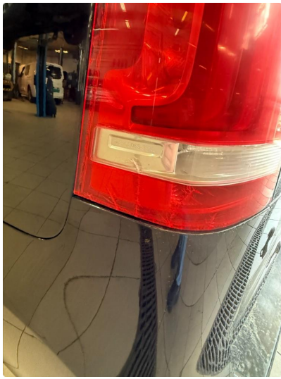
3.1 Defekt / sprukket glass
