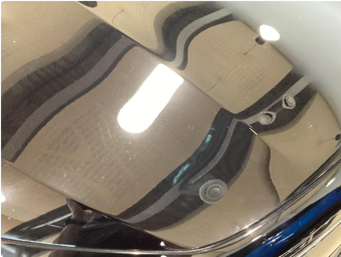
1.1 Små steinsprut på panser
