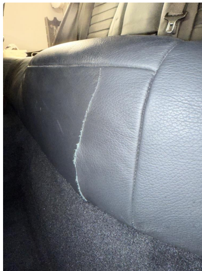
2.1 Skade på setetrekk
