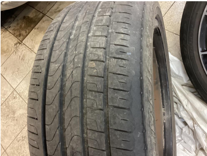
1.2 Skjev slitasje på sommerdekk
