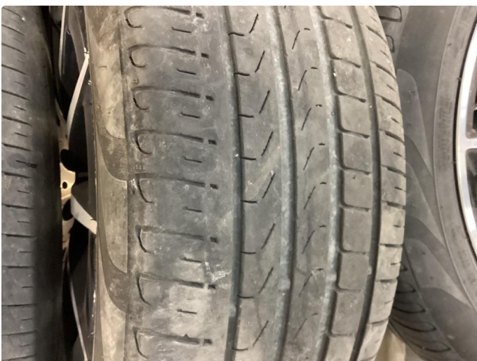
1.2 Skjev slitasje på sommerdekk
