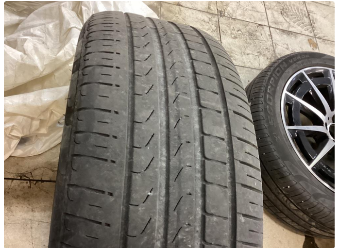
1.2 Skjev slitasje på sommerdekk
