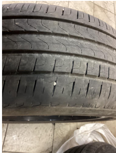
1.2 Skjev slitasje på sommerdekk
