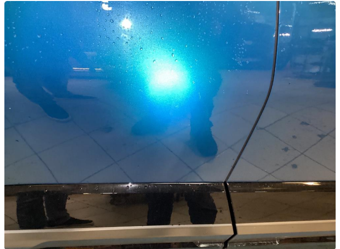
1.1 Ripe ned til grunning
