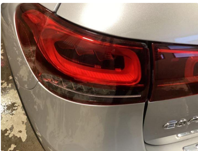
2.1 Sprekk/bit mangler på lykteglass. Ingen lekkasje.
