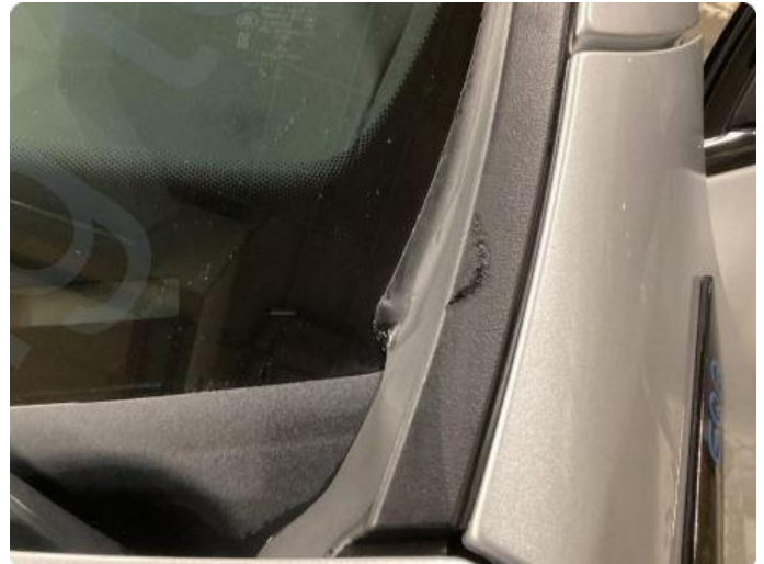
1.4 Skade/merker på pakning, frontrute.
