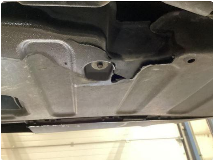
1.1 Beskyttelsesplate under bil skadet.
