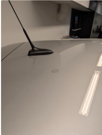
1.2 Rustboble på tak. Pusset ned og lagt i grunning/lakk.
