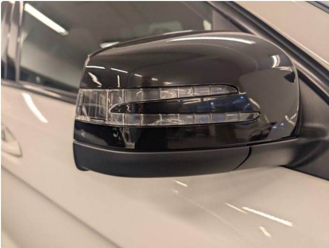
1.1 Krakelering/sprekk i blinklysglasset.
