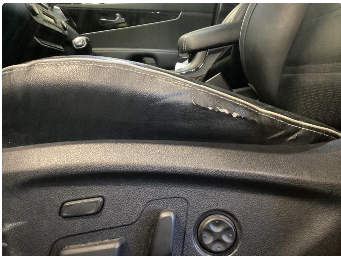
2.1 Skade på setetrekk
