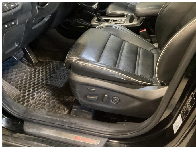
2.1 Skade på setetrekk
