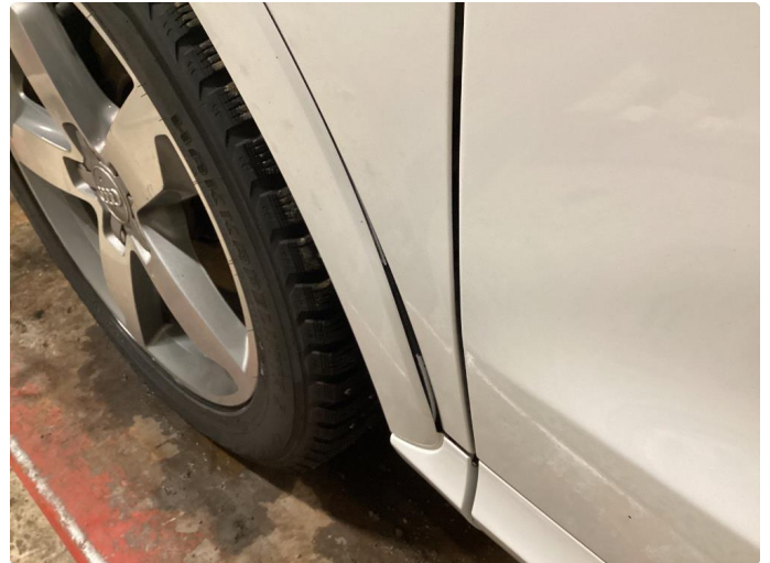
1.1 Skjermutbygger løs - Muligens et dårlig klips
