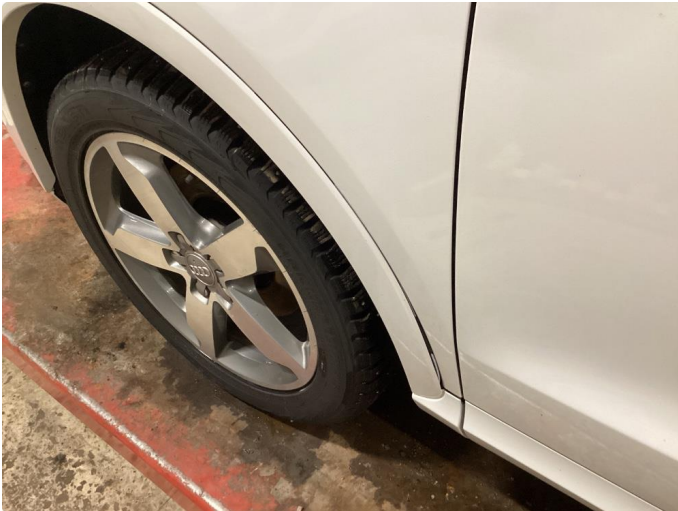
1.1 Skjermutbygger løs - Muligens et dårlig klips
