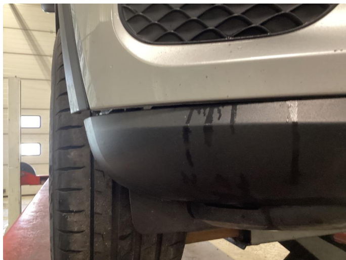
1.5 Locariskjerm flukter ikke - muligens et klips som har løsnet.
