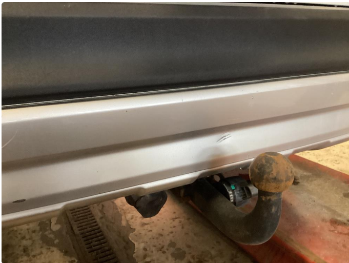
1.1 Skade i plast
