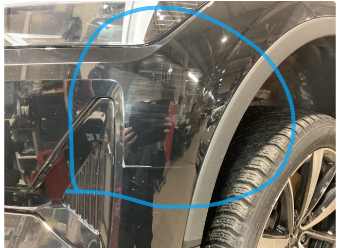
1.3 Ripe(r) ned til grunning
