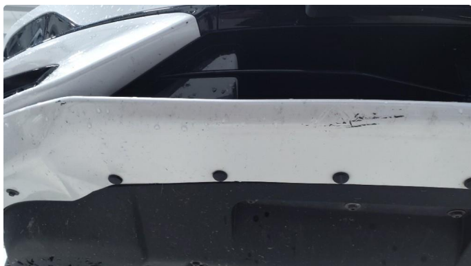
1.1 Riper under støtfanger foran - Normal slitasje
