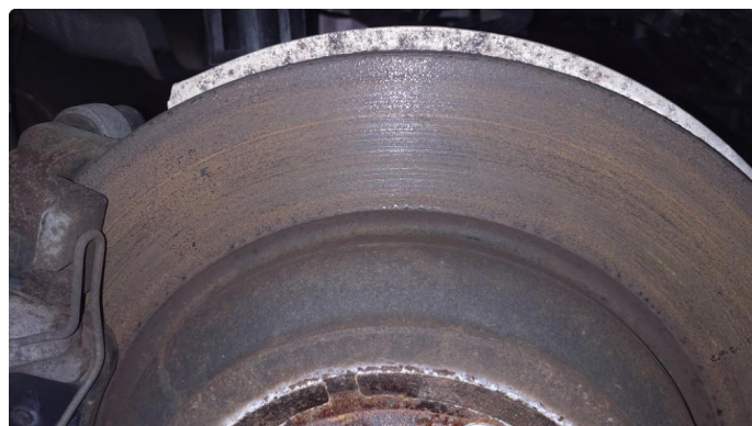
3.1 Rust på bremsler bak - Byttes
