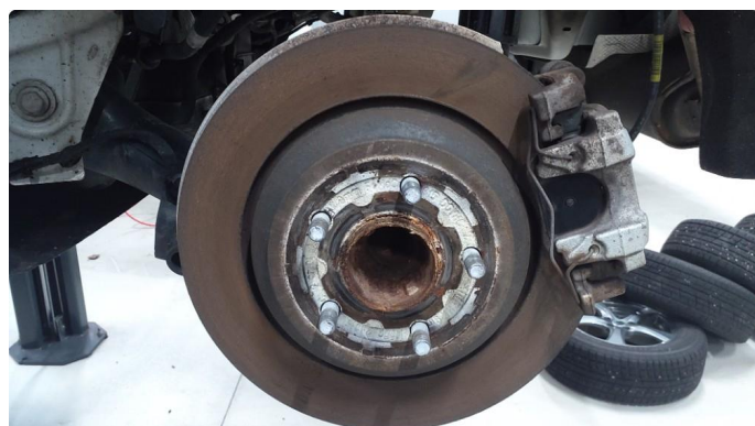
3.1 Rust på bremsler bak - Byttes
