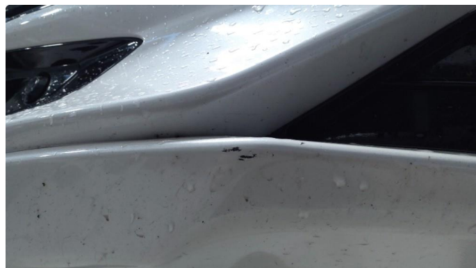
1.1 Riper under støtfanger foran - Normal slitasje
