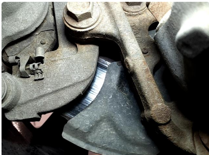
1.1 Mer enn 25% rust - Leveres med nye bremses
