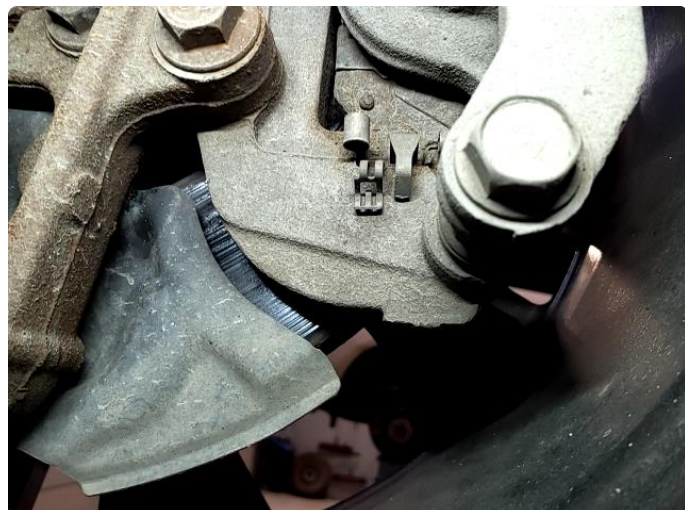
1.1 Mer enn 25% rust - Leveres med nye bremses
