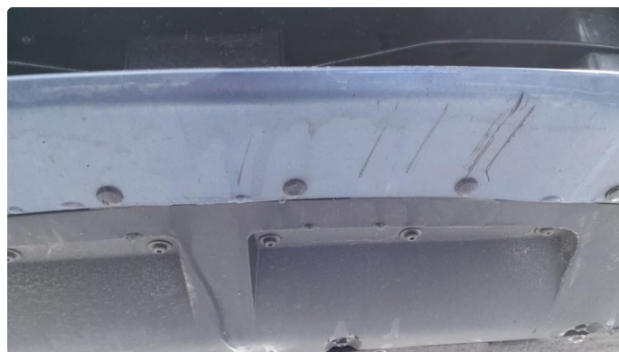
1.2 Riper under støtfanger foran
