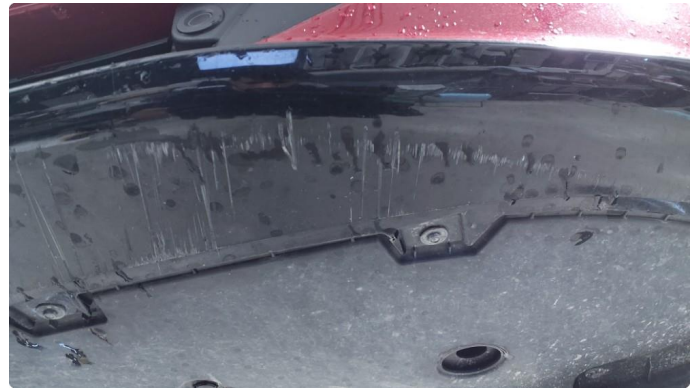
1.1 Riper i plastdel under støtfanger foran
