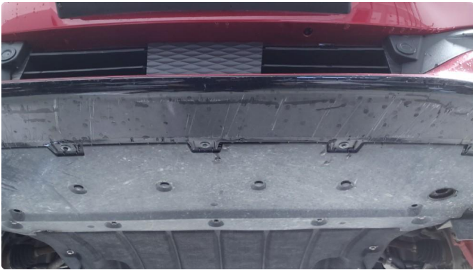
1.1 Riper i plastdel under støtfanger foran
