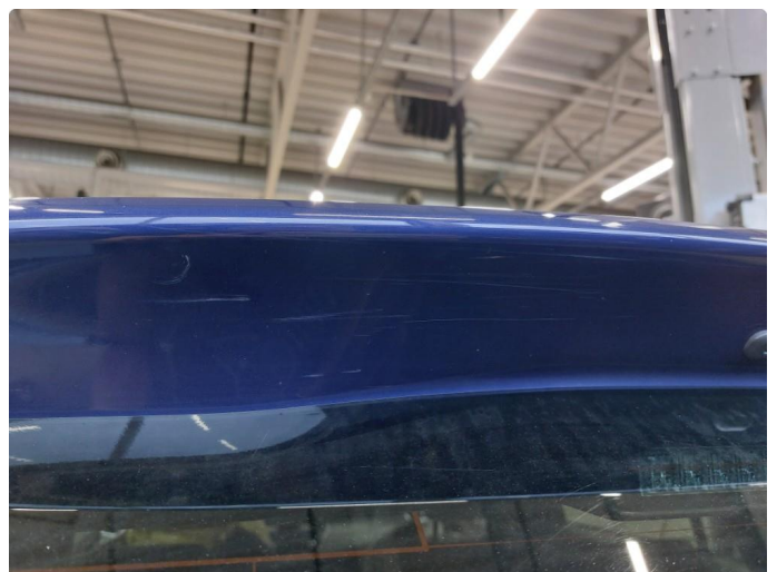
1.1 Noe riper og småbulker
