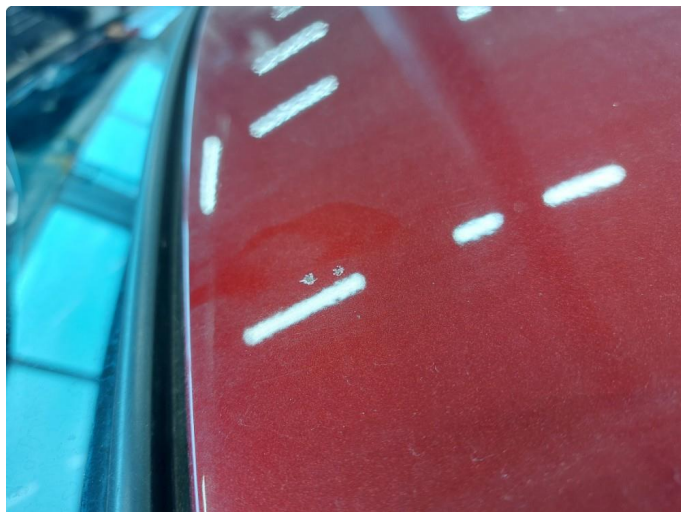
1.3 Steinsprut med rust
