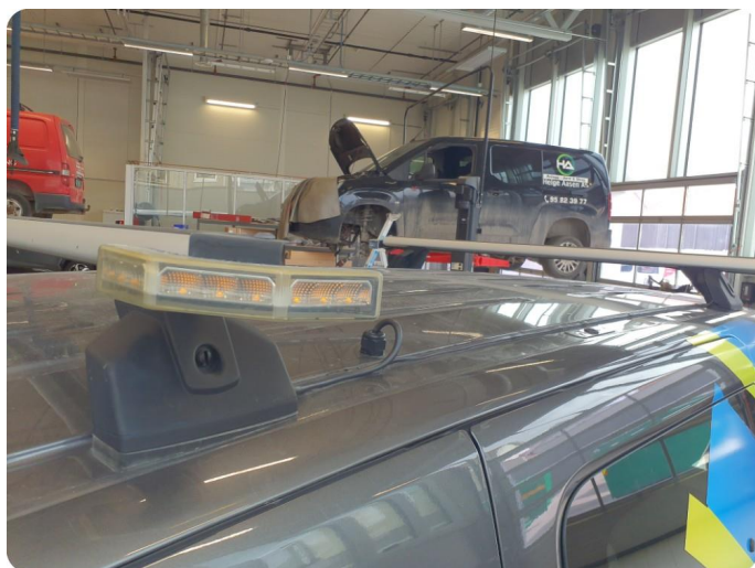
4.2 Demontere spesial/ulovlig utstyr Evt. demontere blinkere. OBS: Hull i tak må tettes.
