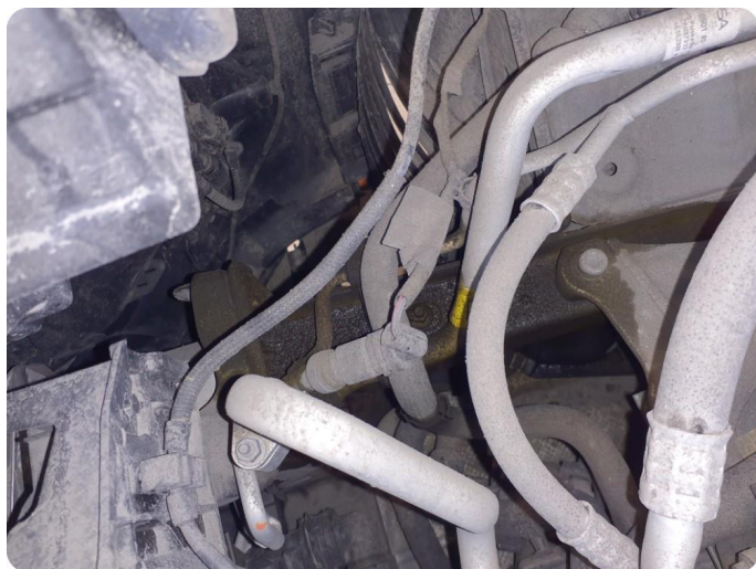
3.1 Svak/uteblitt funksjon på AC Lekkasje. Garanti? Må sjekkes før avreg. Rør lekker.
