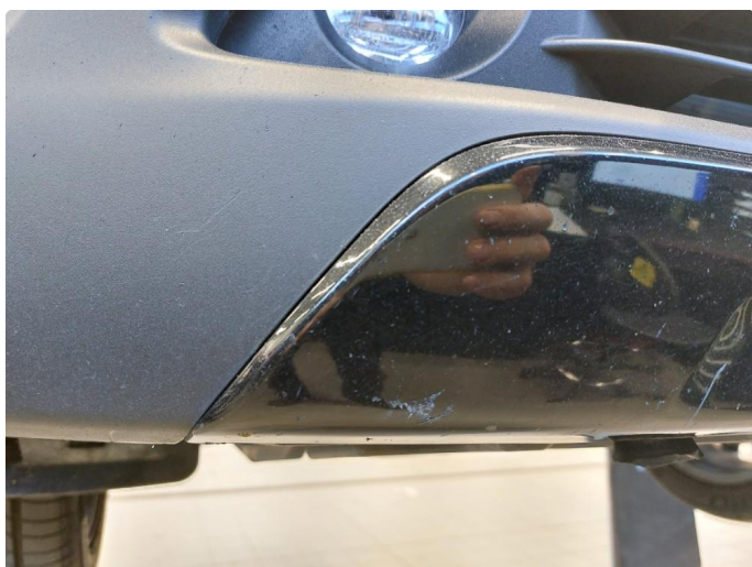
1.1 Noe riper og småbulker
