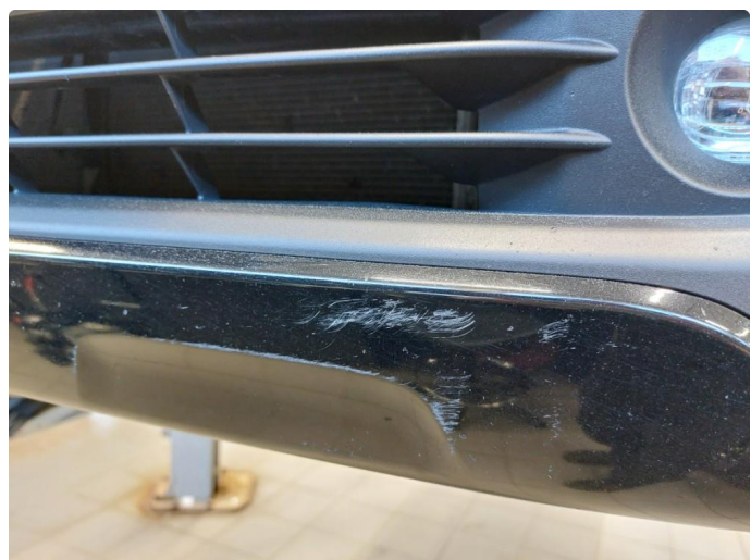
1.1 Noe riper og småbulker
