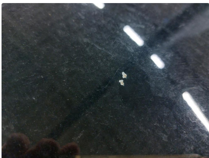
1.2 Steinsprut med rust
