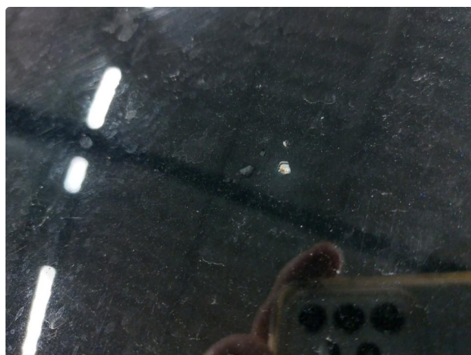
1.2 Steinsprut med rust
