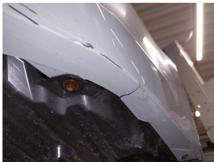
1.3 Liten sprekk under
