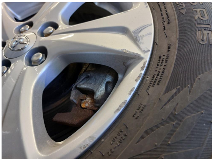
1.3 Skade på felg
