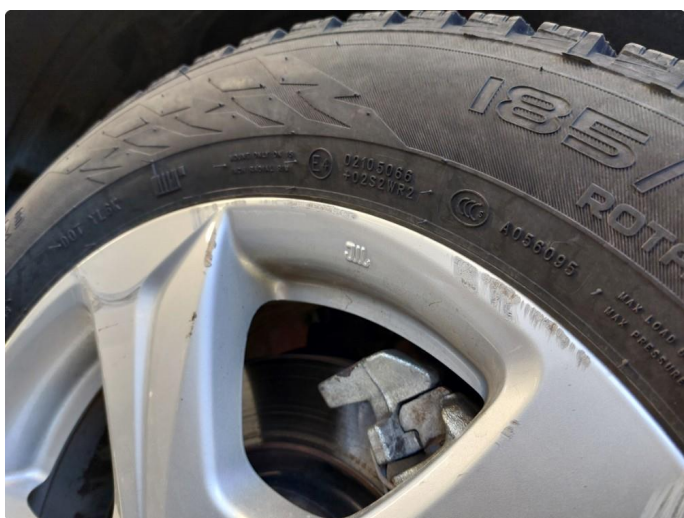
1.3 Skade på felg
