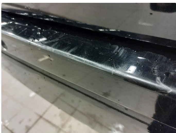
1.1 Noen riper og småbulker
