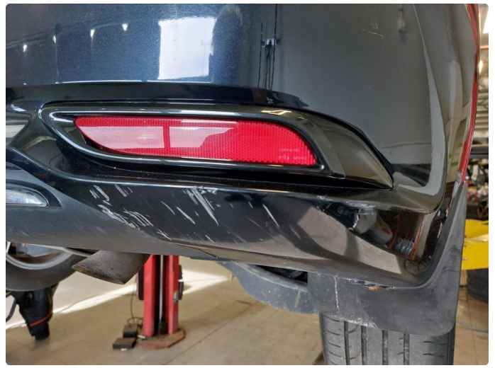
1.1 Noen riper og småbulker/skader
