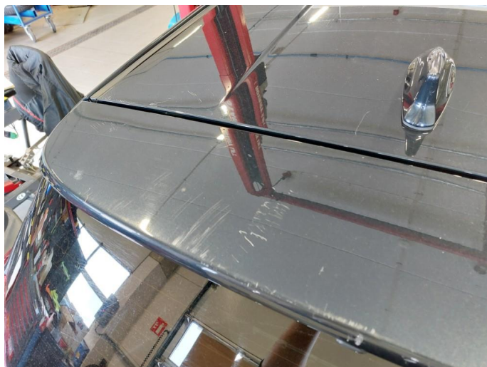
1.1 Noen riper og småbulker/skader
