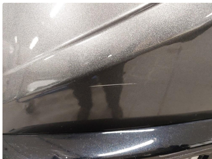
1.1 Ripe(r) ned til grunning
