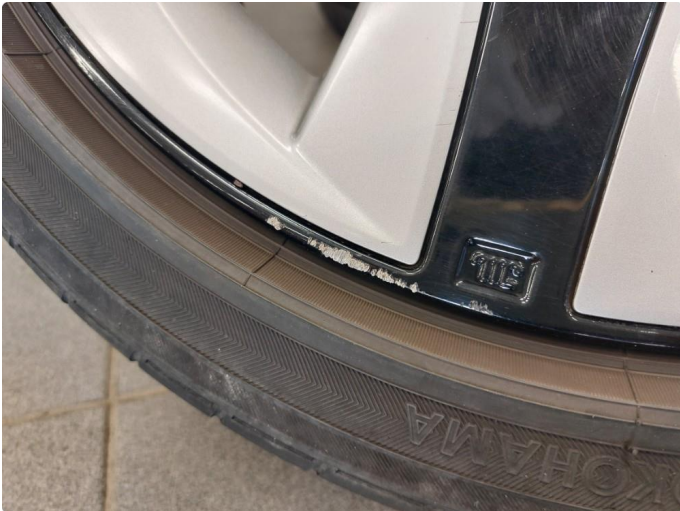
1.1 Små kantskader på felg
