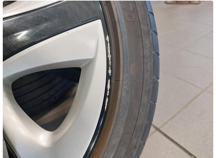
1.1 Små kantskader på felg
